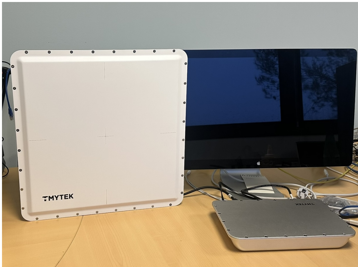
Figure 3: Vue de la RIS TMYTEK 4.7GHz, en cours de test.
